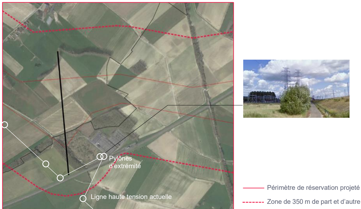
Figure 190 : Superposition du projet et de la ligne haute tension existante (sources : WalOnMap et Google Maps)
