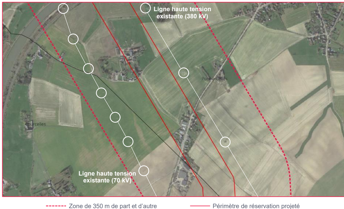
Figure 219 : Superposition du projet de périmètre de réservation et des lignes existantes (source : Google Maps)
