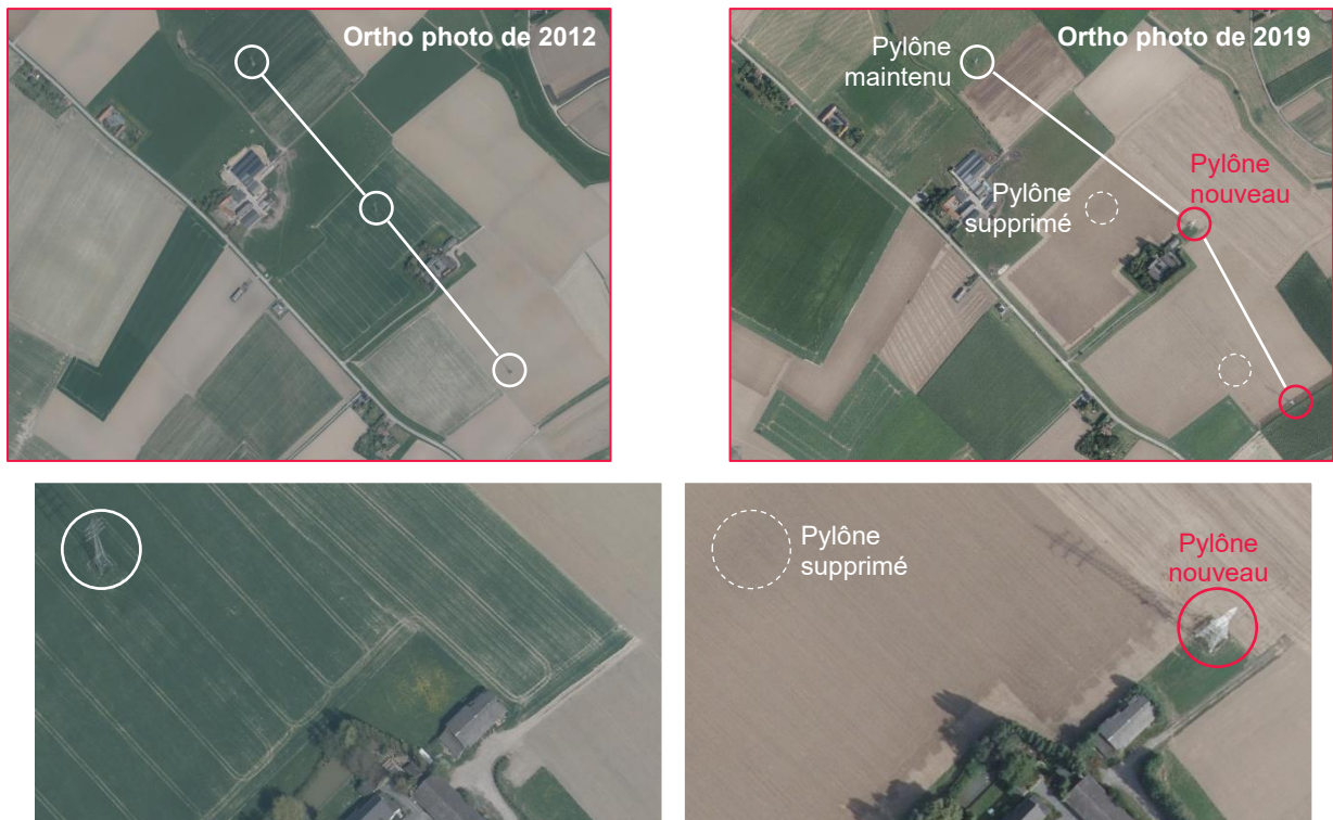
Figure 182 : Comparaison d'orthophotos montrant le déplacement de deux pylônes de la ligne existante (source : WaOnMap)
