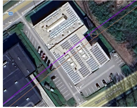
Ligne 150 kV Baudour-Obourg (Pylône 10) : L'entrepôt a été construit en « contournant » le pylône P10. Il en résulte une impossibilité technique de reconstruire ce pylône d'angle en lieu et place.
